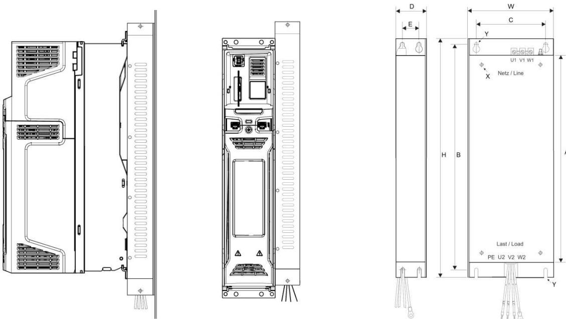
Externe EMC filters frame 3 en 4      3 fase 380-480 V - 50/60 Hz - 40° C      maten in mm
